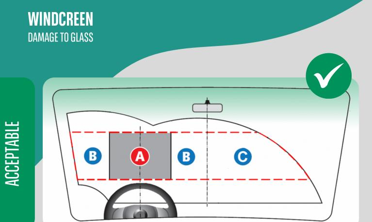
A windscreen with minor repaired stone chips in section B and C are acceptable (K1-K3). Any damage in section A (field of vision) or around the edge of the windscreen is not acceptable (K4-K5). Er der tidligere foretaget stenslagsrep., anbefaler vi rudeskift inden aflevering. Stenslagsrep. anses som en forlængelse af rudens levetid, men garant for, at ruden ikke skal udskiftes.
